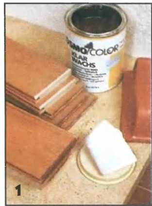
1 Покрытые воском доски дополнительно полируют подушечкой из хлопчатобумажной ткани.
