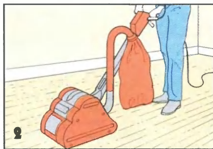
Циклевочная машина прижимается к полу под действием собственного веса. Во время проходов следует избегать остановок, чтобы не врезаться в доски.
